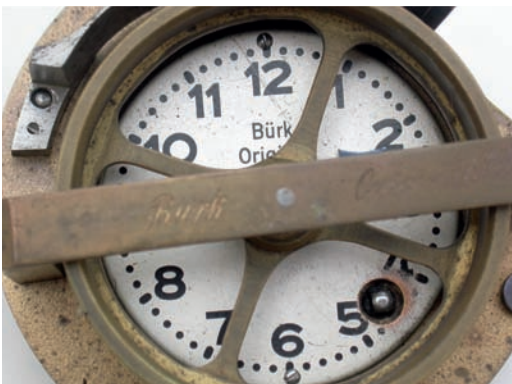
Abb. 4 Steg und Zifferblatt der Streifenuhren
