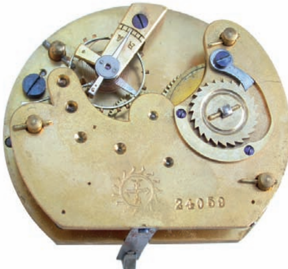
Abb. 3: Uhrwerk Typ 2. Im unteren Bereich ist die Spitze für die Deckelmarkierung zu erkennen.
