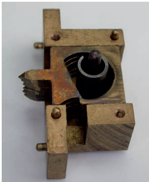
Abb. 12: Beispiel für Markierspitzen mit Gleitbahn nach DRP 305832.
