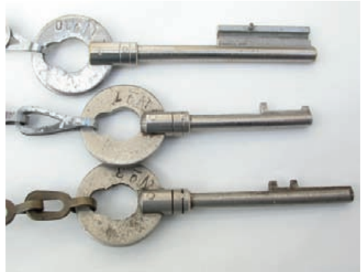
Abb. 10: Markierschlüssel Nr. 3 für Typ 2, 12 Kontrollstellen; Nr. 1 für Typ 2, 6 Kontrollstellen; Nr. 10 für Typ 31, 12 Kontrollstellen.
